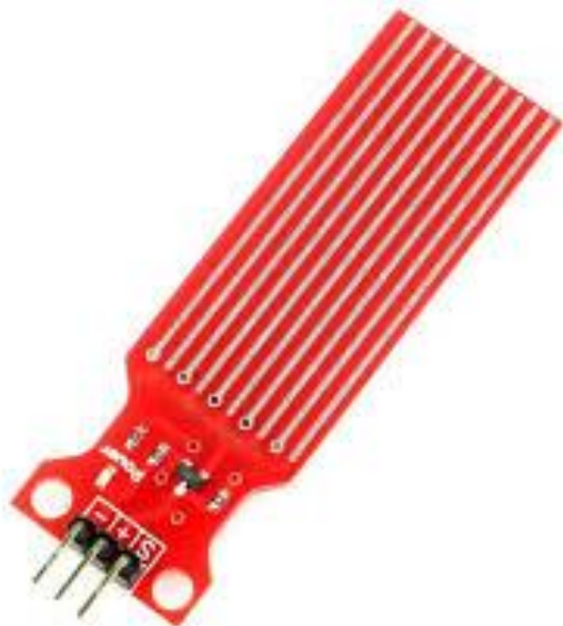
Fig.No:4 Water Level Sensor
