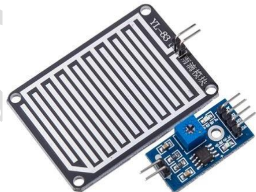
FIG.NO:3 RAIN DROP SENSORS
