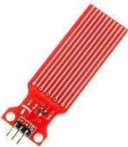
FIG.NO:4 WATER LEVEL SENSOR
